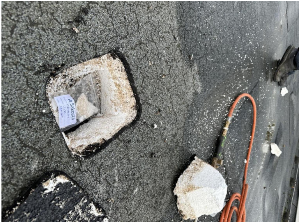
Bild 5: Gebäude A2 – Polystyrol zwischen Dachdämmung und Trapezblech im Dach ist HBCD-haltig. Probe: M62, HBCD-Gehalt: 3600 mg/kg
