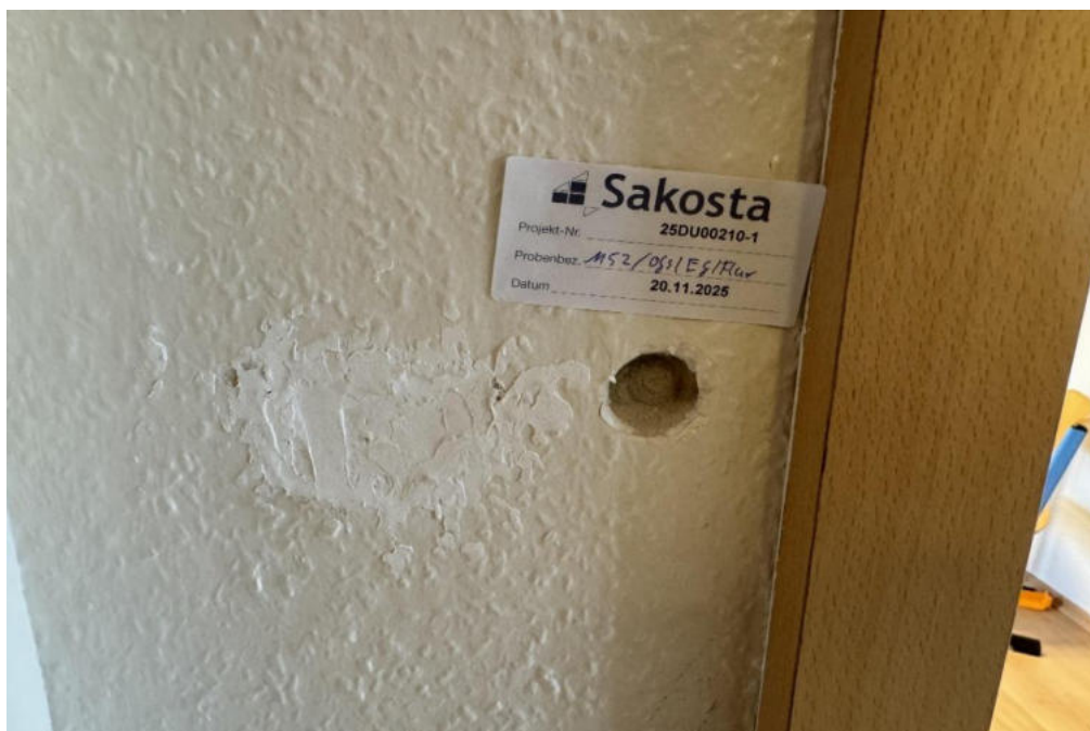
Bild 6: Gebäude Hausmeister – frühere Schadstoffuntersuchungsberichte: Die Wessling GmbH hatte am 08.05.2013 Putz/Anstrich und Spachtelmasse als asbesthaltig eingestuft. Aufgrund des Baujahres des Gebäudes wurde dieselbe Stelle noch einmal untersucht, wobei kein Asbest nachgewiesen wurde.
