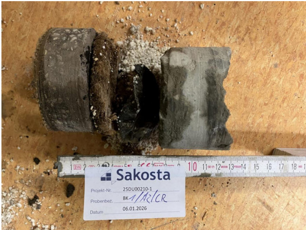
Bilder 3: KMF- Trittschaldämmung unter Bodenbeläge im Erdgeschoss und 1.Obergeschoss im Gebäude A2.
