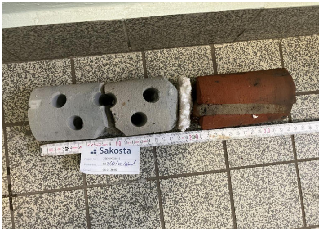
Bilder 4: Polystyrol als Trittschaldämmung im Gebäude Hausmeister und Außenwände Gebäude A2.
